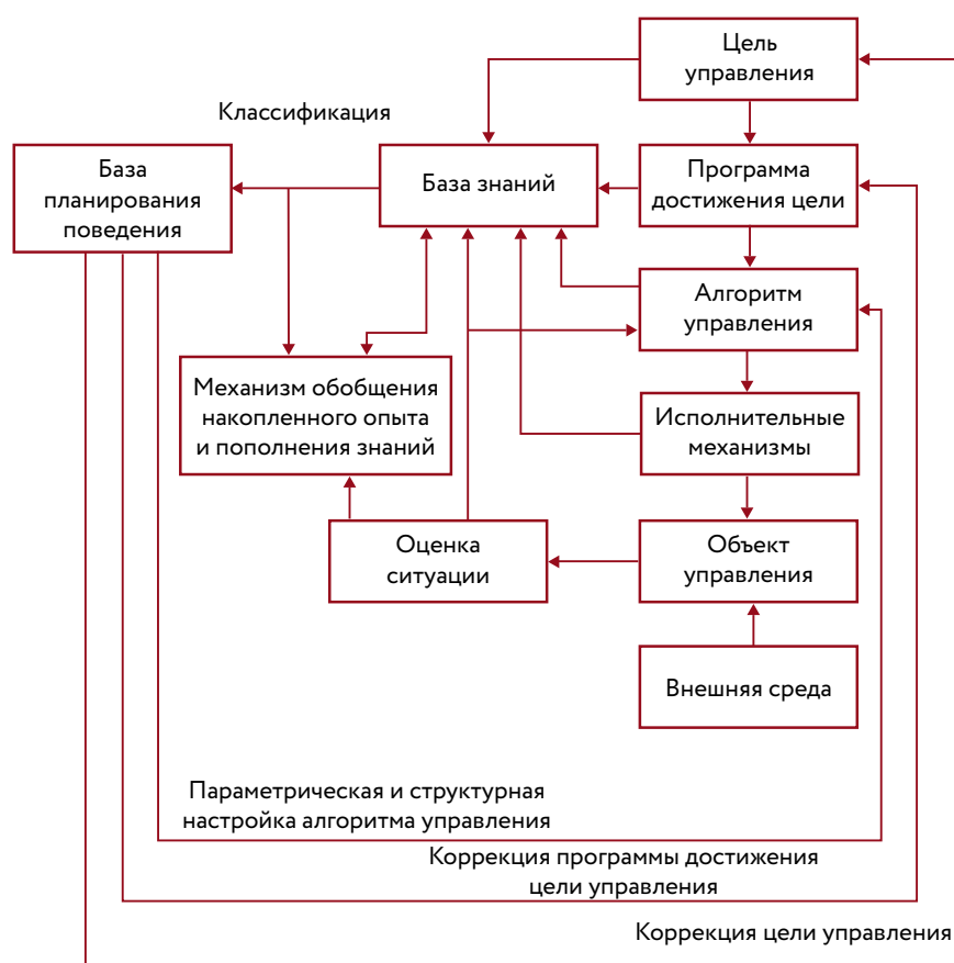
Рис. 2. Схема системы интеллектуального управления ПРТК
