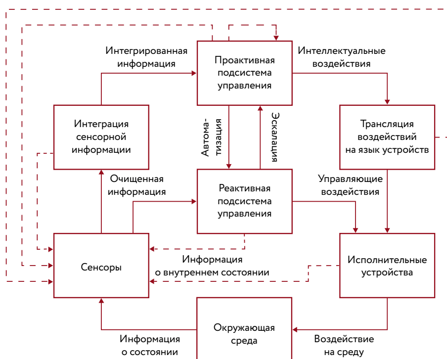
Рис. 3. Схема гибридной интеллектуальной системы
